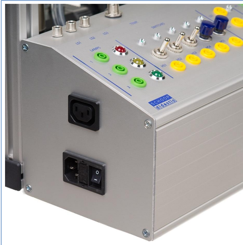
Abbildung 7: Netzanschluss und Anschluss für den Heizstab
