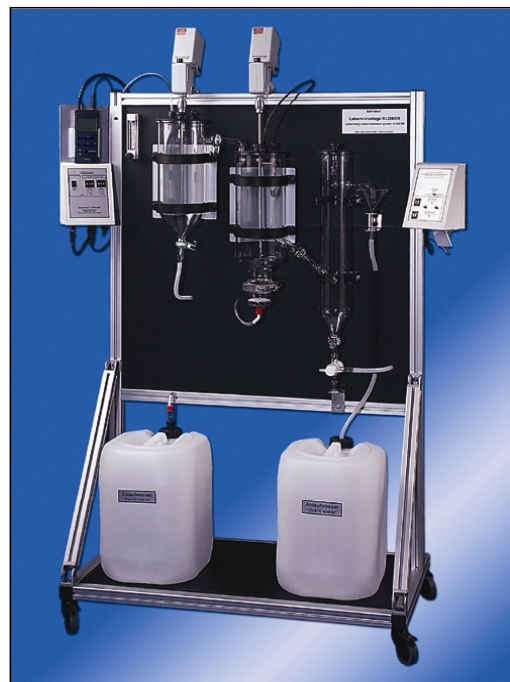
Abbildung 1: Laborkläranlage mit vorgeschalteter Denitrifikation
