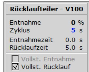
Als weitere Optionen gibt es „Vollständige Entnahme“ (RLT schaltet auf Entnahme, das gesamte Kopfprodukt wird abgezogen; Zyklus und Entnahmeverhältnis werden nicht berücksichtigt), und „Vollständiger Rücklauf“ (RLT schaltet auf Rücklauf, das gesamte Kopfprodukt wird zurückgeführt; Zyklus und Entnahmeverhältnis werden nicht berücksichtigt)
